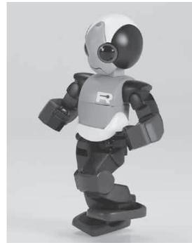
このロボットは、俊敏な動きをスムーズにさせてあげると、より躍動感が出て、生きている感じが増すのではないかなと思いました。そのために新しい機構として、ひざの関節と足の付け根、足首を連動させて動かせるような仕組みを考えまして、それを搭載しています。それはタイミングベルトによって行っています。
