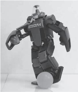
「ビジョン (VisiON)」という自律型のロボットです。頭の部分が全方位カメラという360度が一度に見えるカメラになっています。それをコンピューターで画像処理をして、物体を認識して動き回るといいます。サッカーを通じてロボットの技術を向上させて、ロボットの実用化に向けて進んでいこうということですが、5連覇を達成して、そこでいったん、この参加は終わりました。また、いつか出たいなと思っています。
